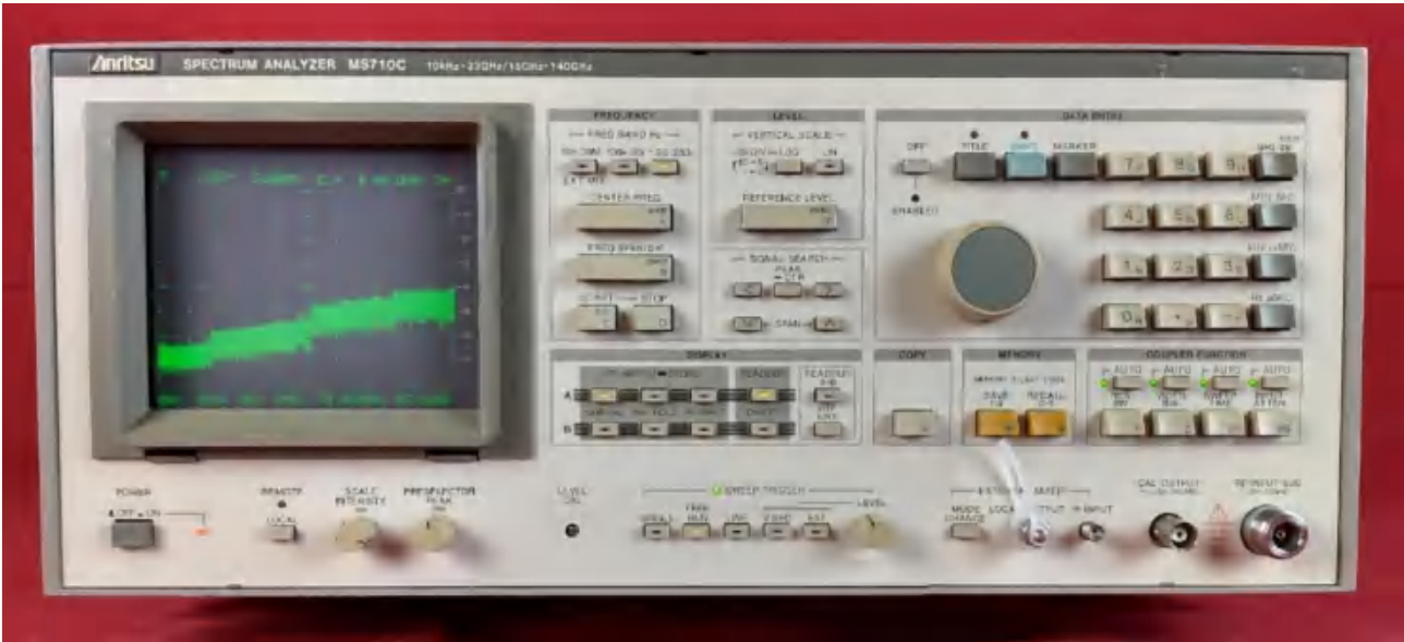
图 1 安立公司具有液晶显示屏的 MS710C 型频谱仪
