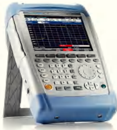
图2 罗德与施瓦茨公司具有普通单点触控显示屏的FSH4系列便携式频谱分析仪
