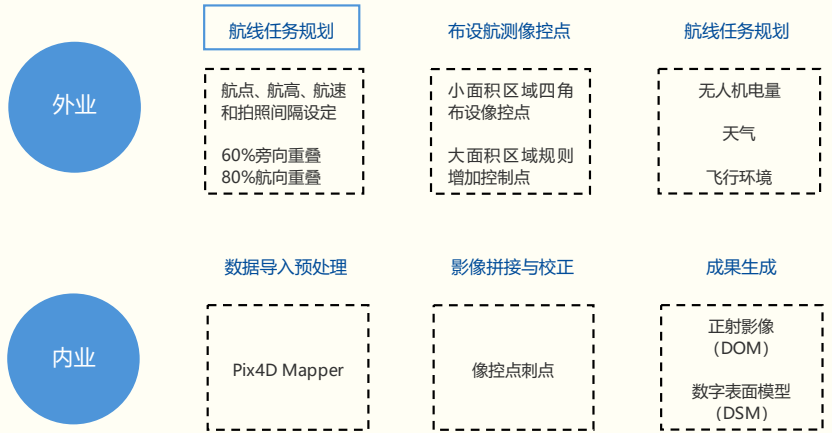
图 1 矿山正射影像合成作业流程图
