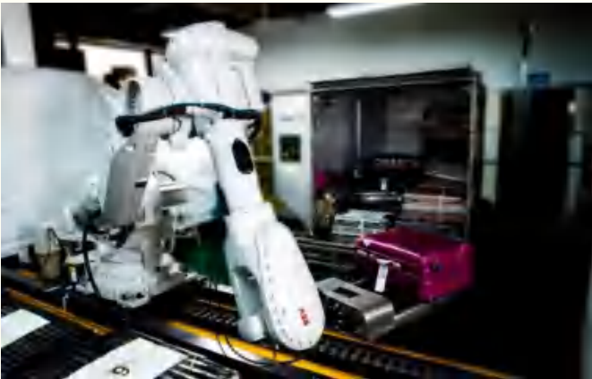
图 1 机械臂将行李装入集装箱
