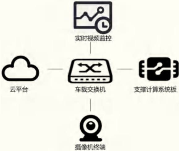
图 1 支撑计算系统板接入视频监控系统
