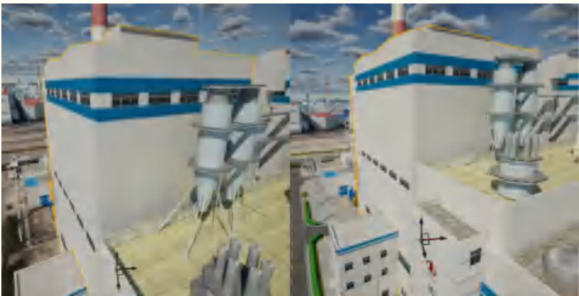
(a) 合并贴图模型近处展示效果 (b) 原模型近处展示效果 图 3 合并贴图模型与原模型近处展示效果对比 (Drawcall:32->2)
