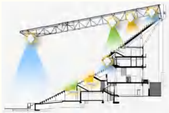
图4 演播厅点位安装示意图
