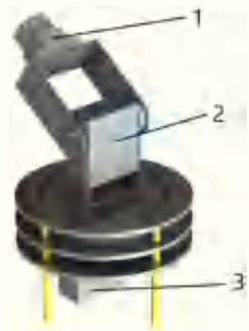
1.K210 摄像头 2. 俯仰舵机 3. 航向舵机 图 4 摄像头移动云台
