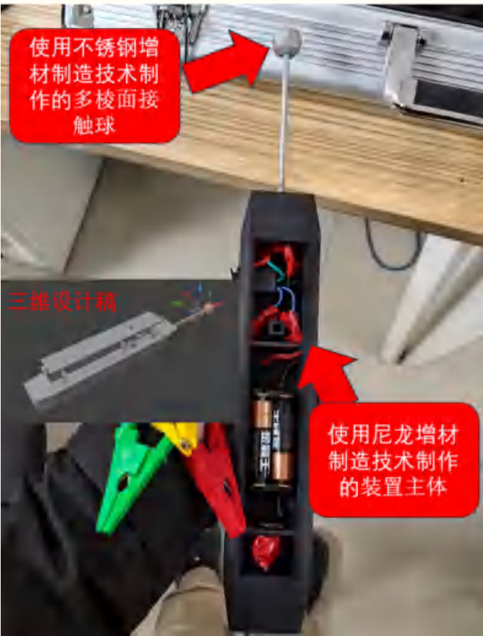
图 2 脉冲发生锤制作过程中的增材制造技术应用
