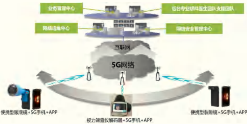
图1 区域眼科互联网远程诊疗和会诊平台网络拓扑结构
