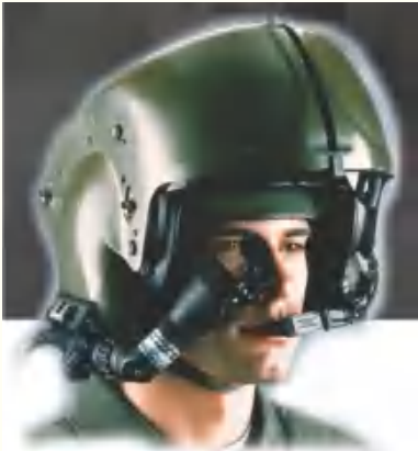
图 2 综合头盔显示瞄准系统（IHADSS）
